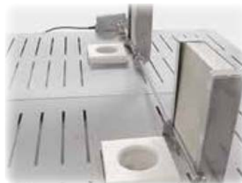
Válvula de salida de aire con control motorizado para acelerar el enfriamiento del horno tras concluir la cocción.
