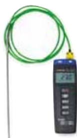
Termómetro para horno RAKU 100, de fácil funcionamiento, de fácil funcionamiento, sensor de temperatura NiCr-Ni, indicador de 20 °C - 1200 °C, posibilidad de conexión con un segundo sensor con cambio de la lectura.
